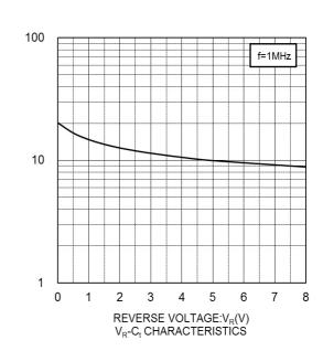
CAPACITANCE BETWEEN TERMINALS:C<sub>t</sub>(pF)
